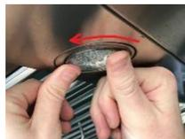
Maintenez votre prise et votre pression sur l'ampoule avec vos pouces pendant que vous tournez l'ampoule dans le sens inverse des aiguilles d'une montre. Cessez de la pousser vers l'intérieur lorsque vous sentez qu'elle ne peut plus tourner (cela doit prendre environ 90 degrés).
