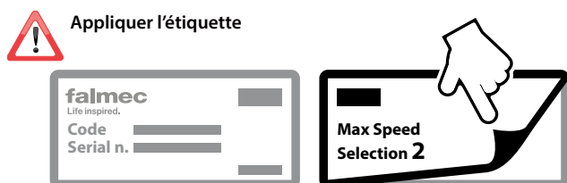
Fig. 2: Configurer 2 vitesses maximum :
