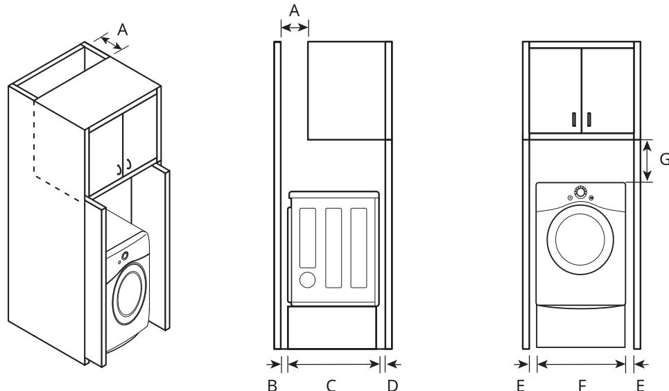
S'il s'agit d'une installation dans une armoire avec porte, des ouvertures de ventilation minimales doivent être pratiquées en haut de la porte de l'armoire.
