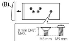
⚠ Utilice solo los tornillos especificados. El uso de tornillos incorrectos puede dañar la unidad.
