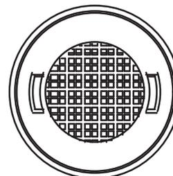
Pour retirer le filtre à charbon du panneau arrière, faites-le tourner dans le sens antihoraire.
