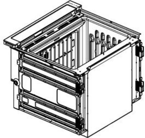
2. Retirer le pied de la cale d'espacement avant droite en ôtant la vis no 8-18 x 3/8 po (9,5 mm).
