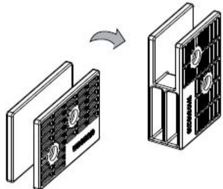
4. Réinstaller le pied de la cale d'espacement à l'aide de la vis de droite en utilisant la vis no 8-18 x 3/8 po (9,5 mm) précédemment retirée.
