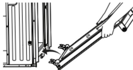
4. S'assurer que les encoches de charnière de la porte sont engagées au fond des fentes de la cavité du four.
