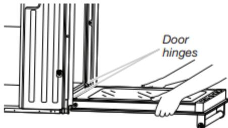
3. Trouver les loquets de charnière de la porte du four dans les deux angles de la porte; faire pivoter les loquets de charnière vers la porte du four jusqu'à la position de déverrouillage. Si le loquet de charnière de porte n'est pas complètement tourné (voir l'illustration B), la porte ne se retirera pas correctement.
