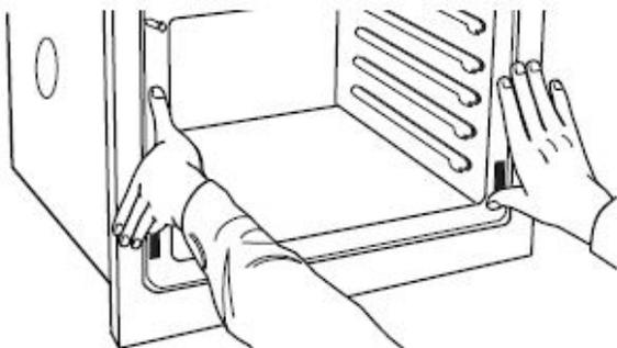
3. Pousser complètement le four dans l'armoire et le centrer dans la découpe de l'armoire.
