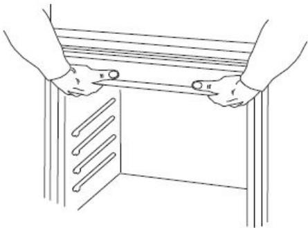
2. Pousser contre la zone du joint du châssis avant pour introduire le four dans l'armoire, jusqu'à ce que la surface arrière du châssis avant soit au contact de la paroi avant de l'armoire.
