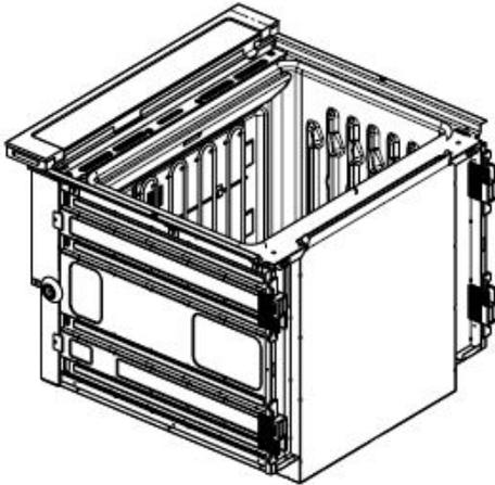
2. Retirer le pied de la cale d'espacement avant droite en ôtant la vis no 8-18 x 3/8 po (9,5 mm).
