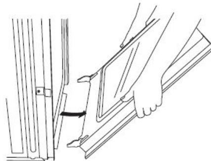
6. Tirer la porte du four vers soi et enlever la porte. Si nécessaire, basculer doucement la porte d'un côté et de l'autre en la tirant.
