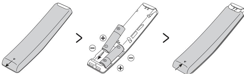
Pour installer les piles, ouvrez le couvercle à l'arrière dans le sens indiqué par la flèche au bas sur l'illustration, et ensuite insérez les piles conformément à l'illustration. Assurez-vous que les polarités positif et négatif donnent dans le bon sens. Fermez le couvercle à l'arrière conformément à l'illustration.
