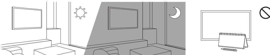
Le capteur Eco ajuste automatiquement la luminosité de l'écran. Il mesure la lumière de votre pièce et optimise automatiquement la luminosité du téléviseur pour réduire la consommation d'énergie. Si vous souhaitez le désactiver, allez à (🏠) > ⚙️ Paramètres > Général > Solution Eco > Détection de l'éclairage ambiant.
