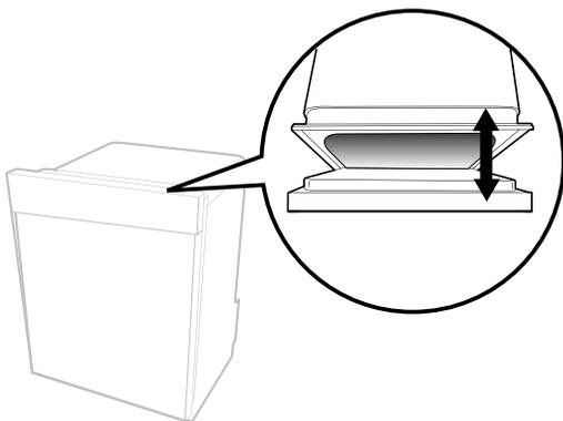
Si les pieds de mise à niveau sont tournés vers la droite (antihoraire), ils sont desserrés et l'avant du lave-vaisselle est surélevé. Et la hauteur maximale à élever est d'environ 50 mm. Si les pieds de mise à niveau sont tournés vers la gauche (horaire), ils sont desserrés et l'avant du lave-vaisselle est abaissé.
