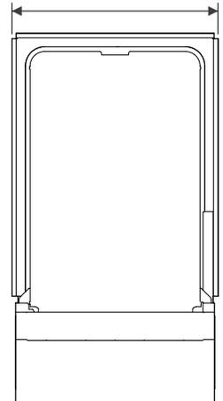
La conduite d'alimentation en eau, le câble d'alimentation et le tuyau d'évacuation doivent passer dans cet espace derrière le lave-vaisselle.
