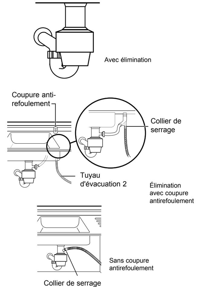
3. Vérifiez la dimension du raccord de tuyau d'évacuation de l'évier (21 mm - comme illustré à la Figure 8 ci-dessous). Si l'extrémité du tuyau d'évacuation ne s'ajuste pas dans le raccord de tuyau d'évacuation de l'évier, utilisez un adaptateur qui est vendu dans une quincaillerie ou une plomberie.
