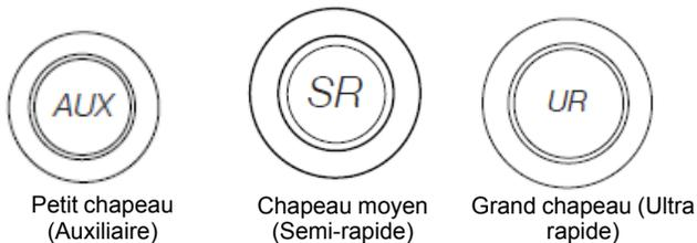
Un chapeau de brûleur correctement placé doit être horizontal. Si les chapeaux de brûleur ne sont pas correctement installés, les brûleurs de surface ne s'allumeront pas. Lorsque le chapeau de brûleur est correctement aligné, il ne balance pas et n'oscille pas.
