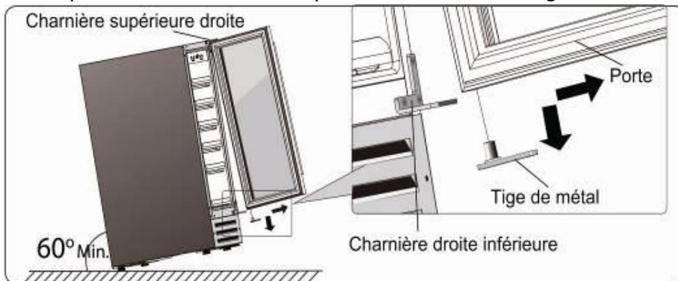
3. Utilisez un petit tournevis à tête plate pour soulever et enlever le capuchon en plastique sur le centre supérieur (trou de verrouillage) de la porte et insérez-le dans le trou central inférieur. Faites une rotation de 180 degrés (sens antihoraire) avec la porte de façon à ce que le haut devienne le bas.
