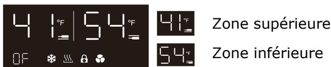
Lorsque le panneau de contrôle est déverrouillé, l'affichage de température indiquera la température préenregistrée et quand le panneau de contrôle est verrouillé, c'est l'affichage de la température réelle qui est affichée.
