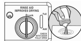
Si la performance de séchage est mauvaise, essayer un réglage plus élevé. Tourner le régleur à flèche sur un chiffre plus élevé pour ajouter davantage d'agent de rinçage.
