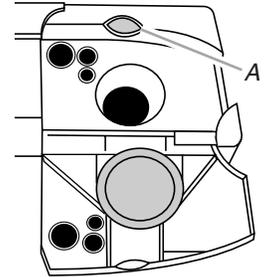
**REMARQUE :** Pour une majorité de types d'eau, le réglage effectué à l'usine à 2 donnera de bons résultats. En cas d'eau dure ou d'observation d'anneaux ou dépôts, essayer un réglage plus élevé. Tourner l'ajusteur à flèche à l'intérieur du distributeur soit à la main, soit en insérant un tournevis à lame plate au centre de la flèche et en tournant.
