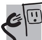
Nunca, bajo ninguna circunstancia, corte o elimine el tercer cable (tierra) del cable de corriente.
