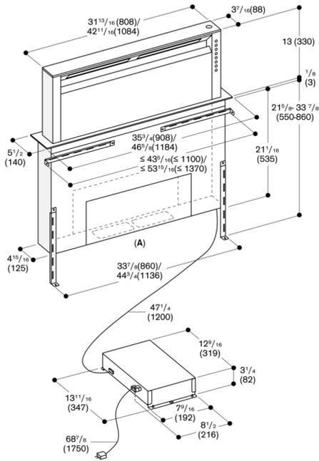
A: Connexion flexible de la hotte à l'avant, à l'arrière ou en bas
