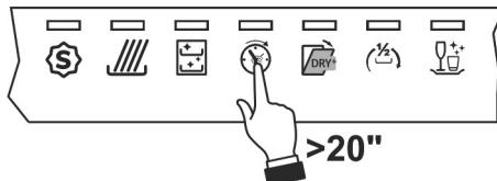
À la suite du réglage ou de l'affichage de celle qui est configurée, il suffit de relâcher le bouton pendant quelques secondes, et le lave-vaisselle se remet automatiquement à l'état standard en quittant le mode réglage.
