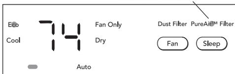
Remarque : Lorsque le filtre PureAir™ est installé, l'indicateur du Filtre PureAir™ s'allume en blanc.
