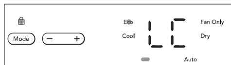
Remarque : Maintenez les boutons « Vitesse du ventilateur » et « Réinitialisation du filtre » enfoncés pendant 3 secondes pour activer ou désactiver la fonction VERROUILLAGE. L'écran indiquera VR pendant 5 secondes. Le panneau de commande est verrouillé et le réglage ne peut pas être modifié.
