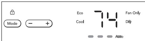
Remarque : Dans ce mode, le climatiseur fonctionnera comme un déshumidificateur, mais il refroidira la pièce pendant ce temps. La température peut être réglée 62 °F (17°C) et 86 °F (30 °C) et la vitesse du ventilateur est maintenue à « ventilateur automatique ».
