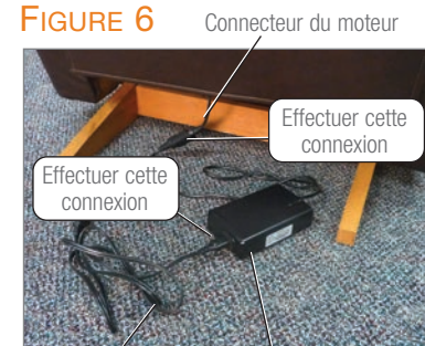
Connecteur du moteur Effectuer cette connexion Cordon d'alimentation 120 volts Source d'alimentation* 120 volts
