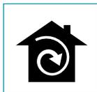
Dans cette version, l'air passe à travers les filtres au charbon et zéolite pour être purifié et est recyclé dans la pièce. Contrôler que les filtres au charbon soient montés sur la hotte, sinon les appliquer comme indiqué dans les instructions de montage.
