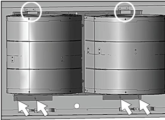
5. Positionnez la plaque du ventilateur double sur les supports de montage du mur arrière intérieur à l'intérieur du corps de la hotte. Fixez à l'aide des (4) vis précédemment retirées à l'étape 2. Rebranchez la fiche du ventilateur.
