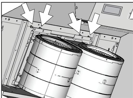
2. Retirez les (4) vis de l'intérieur du corps de la hotte fixant la plaque du ventilateur au haut du corps de la hotte. Retirez le ventilateur et la plaque du ventilateur.
