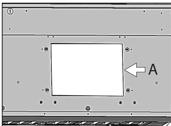
3. Plaque défonçable A pour les conduits horizontaux à double soufflante.
