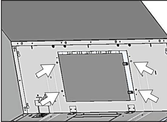
4. Depuis l'intérieur du corps de la hotte, placez la plaque de couverture supérieure sur le dessus du corps de la hotte. Depuis l'extérieur du corps de la hotte, fixez la plaque de couverture supérieure au haut du corps de la hotte à l'aide de (4) vis 3/16 x 3/8.
