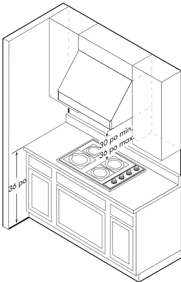
Un conduit rond d'au moins 10 po est recommandé pour maintenir une efficacité maximale du débit d'air.
