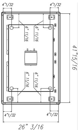
Abrir los paneles de acero inoxidable y sacar los filtros antigrasa para no dañarlos y para poder efectuar la instalación, insertar las varillas en los tacos, como se muestra en la fig.5.
