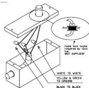
Les tiges filetées mesurent 9"13/16 et servent au montage de la hotte à plafond pour une distance du plafond solide comprise entre 9"13/16 et 14"9/16, comme indiqué dans la Fig. 6.
