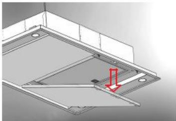
Après avoir choisi la position la plus appropriée, réalisez la canalisation : un conduit ayant un diamètre de 6" à installer sur le côté de l'appareil choisi pour la sortie d'air est fourni avec le produit. Laissez fermés les trous pour la sortie d'air pas utilisés, comme indiqué dans la Fig. 2.
