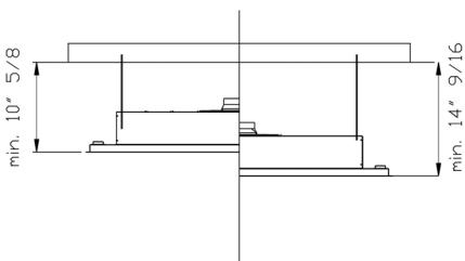
En caso de que la distancia entre la campana y el techo sea mayor, se tiene que utilizar una varilla más larga. Conectar un cable de alimentación a la caja de alimentación metálica puesta en el interior de la campana, como se muestra en la fig.7.
