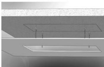
Effectuez 4 trous dans le plafond selon les dimensions, comme indiqué dans la Fig. 4, et insérez les tasseaux en plastique fournis dans les trous.
