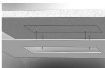
Efectuar 4 orificios en el techo según las dimensiones, como se muestra en la fig.4, y insertar en los orificios los tacos de plástica que encuentra en la caja del producto.
