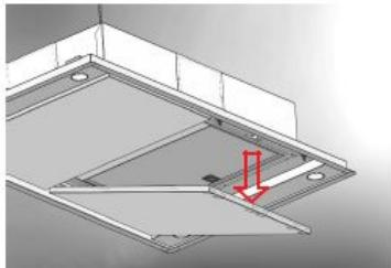
Después de haber elegido la mejor posición, preparar la canalización: una unión del diámetro de 6" t para instalarlo en el lado del producto escogido para la salida de aire, que se adjunta en la caja de este producto. Mantener cerrado cada orificio para la salida de aire que no se use, como se muestra en la figura.2
