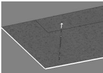
Las varillas tienen una longitud de 9"13/16 y sirven para poner la campana en el techo a una distancia del techo sólido entre unos 10"5/8 y unos 14"9/16, como se muestra en la fig.6.
