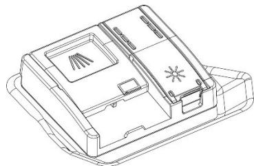
Le produit de rinçage accélère le séchage de la vaisselle et empêche la formation de taches et de dépôts de calcaire; il est automatiquement ajouté à l'eau au cours du dernier rinçage à partir du réservoir qui se trouve sur le côté intérieur de la porte.
