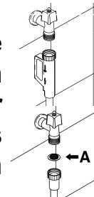
Dans les modèles dotés d'AQUASTOP, le filtre est déjà présent dans la bague filetée.
