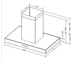
Hauteur d'installation recommandée au-dessus de la surface de cuisson : de 24 à 30 po.
