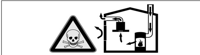
Les foyers à air ambiant (par exemples les chauffages à gaz, à bois, à fioul ou à charbon, les chauffe-eau instantanés, les ballons d'eau chaude) prennent l'air de combustion dans la pièce où ils sont installés et rejettent les gaz de fumée à l'air libre par un dispositif spécifique (cheminée par exemple).
