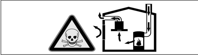
Los equipos con fuego dependiente del aire de la habitación (p. ej. calefactores de gas, aceite, madera o carbón, calentadores de paso, equipos para preparar agua caliente) toman el aire para la combustión de la habitación donde están colocados, y canalizan hacia afuera los gases por una instalación al efecto (p. ej., una chimenea).
