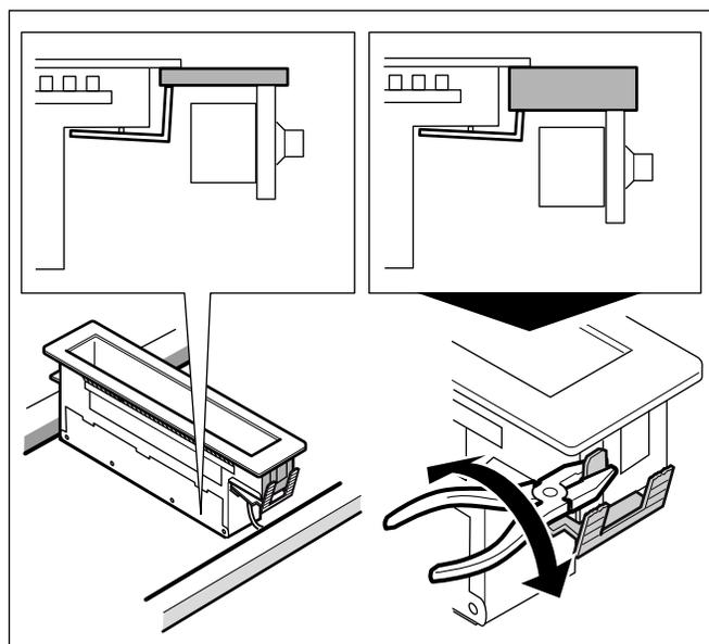
Introducir en posición horizontal el aparato en el agujero y alinearlo. Apretar el tensor de la zona de cocción con los tornillos en la parte interior del aparato. Apretar el tensor de la zona de cocción delantero desde abajo.
