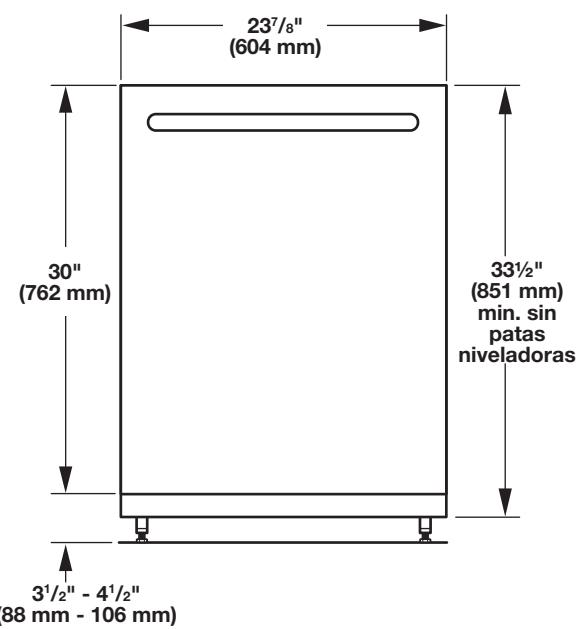
Para un zócalo de 4" (100 mm), la altura de la abertura del gabinete es de 34 1/2" (876 mm).
