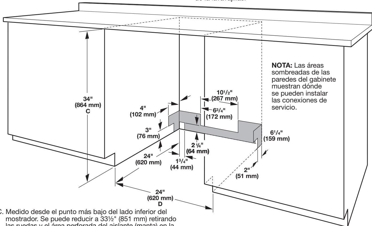
C. Medido desde el punto más bajo del lado inferior del mostrador. Se puede reducir a 33 1/2" (851 mm) retirando las ruedas y el área perforada del aislante (manta) en la lavavajillas.
