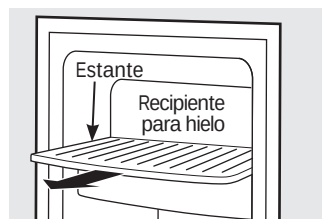
Para alcanzar el interruptor eléctrico.
