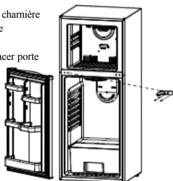
Placez la porte du réfrigérateur sur la charnière inférieure. Assurez-vous que la porte soit alignée horizontalement et verticalement. Attachez la charnière centrale sur la partie supérieure (à gauche) de la porte du réfrigérateur, alignez les trous et fixez à la poutre centrale avec les vis gardées. Fixer avec un tournevis (non inclus).
