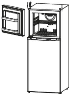
Placez la porte du congélateur sur la charnière centrale. Faire en sorte que la porte soit alignée horizontalement et verticalement, et que les joints puissent être étanches sur toutes les faces avant de fixer la charnière supérieure. Fixez la charnière supérieure et le couvercle de la charnière.
