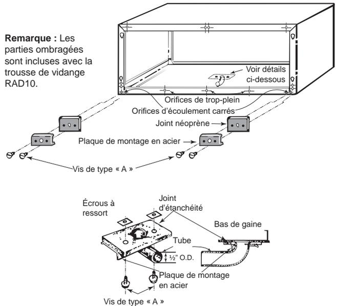
2. Avec un dispositif de vidange extérieur (qu'on peut raccorder à un tuyau de vidange acheté localement), l'eau de condensation peut être évacuée à l'écart de l'appareil et du bâtiment.
