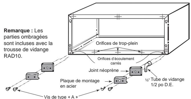
**REMARQUE:** Il pourrait être souhaitable ou nécessaire d'installer une trousse de vidange sur le manchon avant d'installer le manchon dans le mur.
