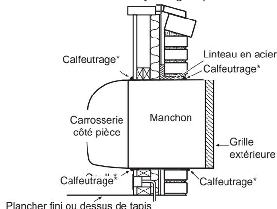
**REMARQUE: \*Il est essentiel de calfeutrer le périmètre du manchon mural des quatre côtés sur l'extérieur et le côté pièce à l'endroit où il rejoint le bâtiment pour éviter l'infiltration d'air et d'eau.**
