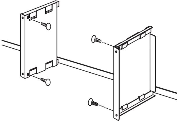
3. Fixez le support supérieur (avec un joint d'étanchéité en mousse) sur les dispositifs de répartition d'air à l'aide des deux (2) goupilles-poussoir fournies.
