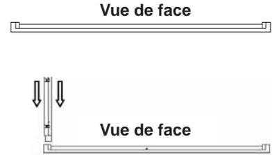
3. Repérez le panneau latéral droit. Alignez le panneau sur la fente du panneau inférieur droit. Insérez le panneau droit dans le panneau inférieur jusqu'à ce que les languettes se verrouillent complètement.
