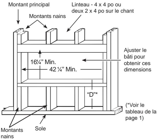
**REMARQUE :** Utilisez un linteau pour soutenir une brique, un bloc, etc., au-dessus du manchon de climatiseur. (Il n'est pas nécessaire d'utiliser un linteau immédiatement sous un seuil de fenêtre.)
