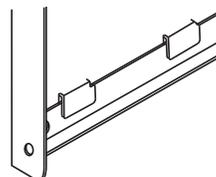
Assurez-vous que le panneau s'engage avec la languette sur les panneaux inférieur et supérieur correctement
