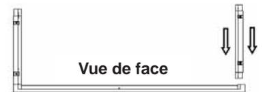
4. Repérez le panneau supérieur et alignez-le sur le dessus des panneaux latéraux gauche et droit. Insérez le panneau supérieur dans les panneaux latéraux gauche et droit jusqu'à ce que les languettes se verrouillent.
