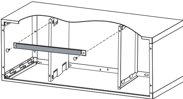
4. (Au besoin) Repérez la barrière ignifuge et fixez-la à l'arrière du manchon assemblé à l'aide des quatre (4) goupilles-poussoir fournies.
