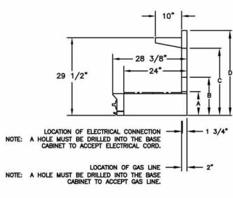
A - ISLAND TRIM HEIGHT - 9 1/16" B - 6" STANDARD BACKGUARD HEIGHT - 14-9/16" C - 17" BACKGUARD HEIGHT - 25-9/16" D - HIGH SHELF BACKGUARD HEIGHT - 32 5/16"
