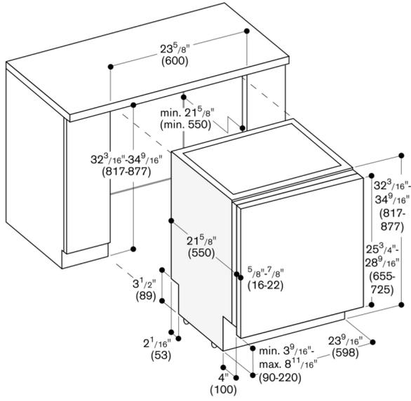
Dimensions de raccordement pour un lave-vaisselle de 24" (600 mm) de large
