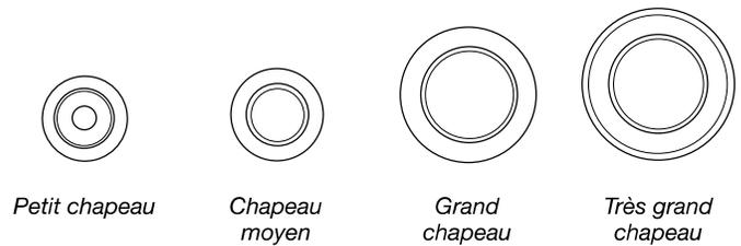
Un chapeau de brûleur correctement placé doit être horizontal. Si les chapeaux de brûleur ne sont pas correctement installés, les brûleurs de surface ne s'allumeront pas. Lorsque le chapeau de brûleur est correctement aligné, il ne balance pas et n'oscille pas.
