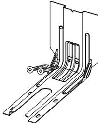
5. À l'aide des deux vis à tête Phillips n° 10 x  $1\frac{5}{8}$ " (4,1 cm) fournies, visser la bride antibasculement au mur ou au plancher.
