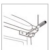
12. Placer la porte du congélateur sur son pivot. Assurez-vous que le joint d'étanchéité soit aligné horizontalement et verticalement puis installez et serrez en dernier lieu la charnière supérieure. Par la suite, recouvrir la charnière du cache charnière inclus dans le sac d'accessoires avant de le visser.
