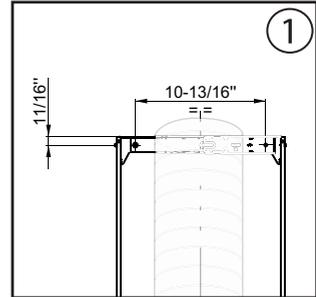
3. Fixez l'étrier à la paroi à peine sous le plafond en utilisant les (2) vis A. Fig. 2
