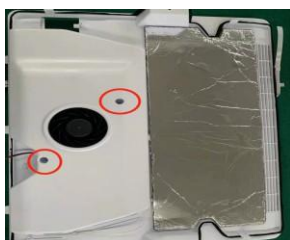
6. Remove the fan cover
