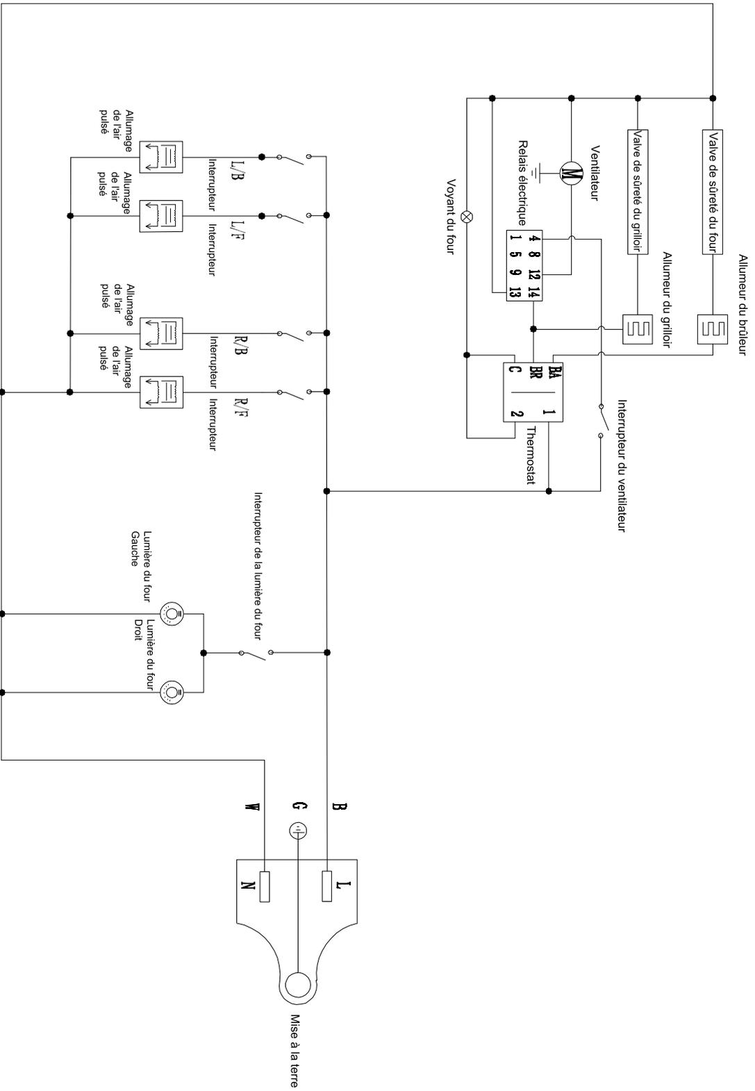
**Mise en garde :** Marquez tous les fils avant de les débrancher lors de l'entretien des commandes. Les erreurs de câblage peuvent entraîner un dysfonctionnement et des dangers. Vérifiez le bon fonctionnement après l'entretien.
