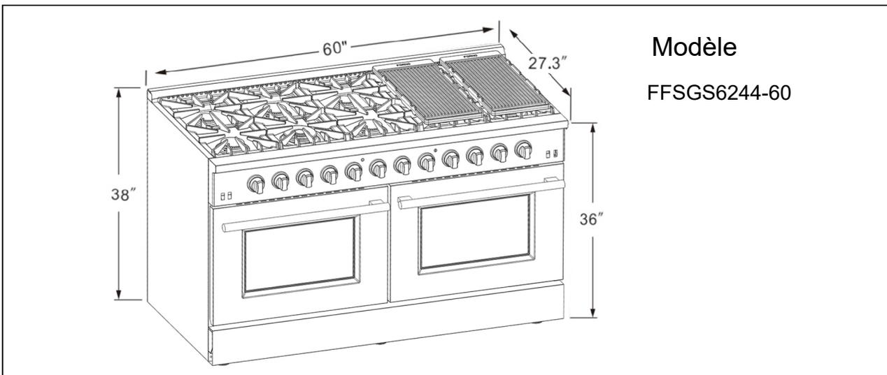
Cette cuisinière peut être installée directement à côté des armoires existantes à une hauteur de comptoir (36 po ou 91,5 cm du sol). Pour obtenir le meilleur aspect possible, la table de cuisson doit être au même niveau que le comptoir de l'armoire. Cela peut être obtenu en soulevant l'unité à l'aide des tiges de réglage sur les pieds.
