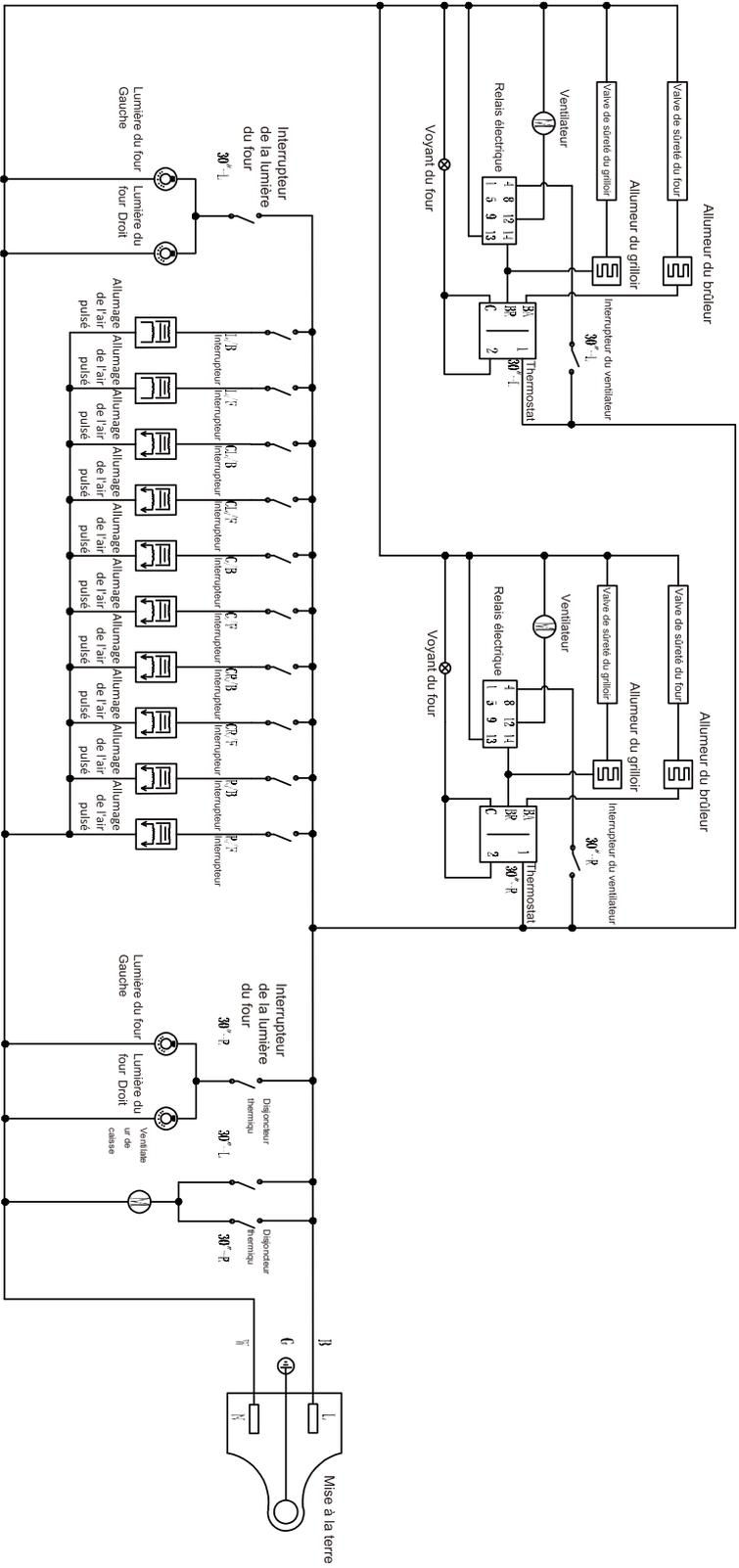
**Mise en garde :** Marquez tous les fils avant de les débrancher lors de l'entretien des commandes. Les erreurs de câblage peuvent entraîner un dysfonctionnement et des dangers. Vérifiez le bon fonctionnement après l'entretien.
