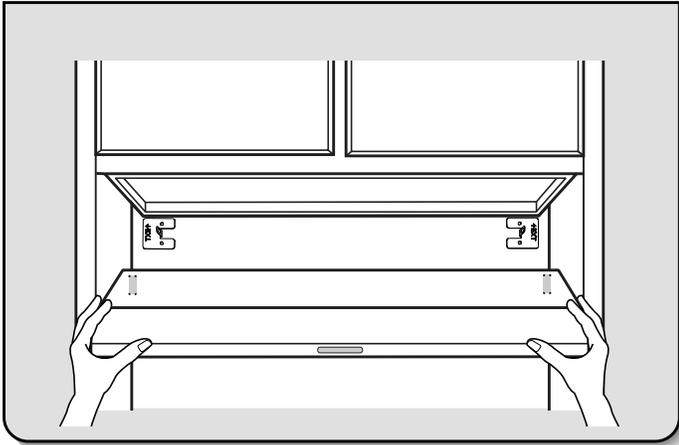
Soulever la hotte et la mettre en place, et insérer les pattes des brides de montage dans les fentes situées à l'arrière de la hotte.
