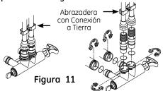
Asegure la abrazadera con conexión a tierra a las tuberías de metal.
