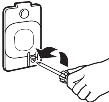
3. Tourner l'ampoule dans le sens antihoraire. Remplacer l'ampoule uniquement par une ampoule de 10 watts pour appareil électroménager. Réinstaller le couvercle et le fixer avec la vis.
