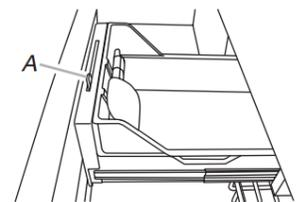
*A. Palanca del depósito de hielo*
