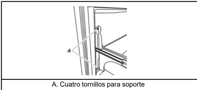
3. Levante el frente del cajón hacia arriba y por encima de los tornillos.
