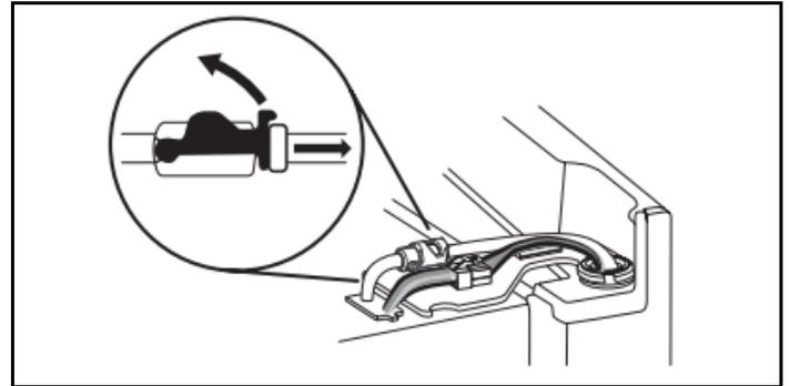
3. Antes de sacar la puerta del lado izquierdo, desconecte el enchufe de cableado que está ubicado sobre la bisagra superior introduciendo un destornillador de cabeza plana o la uña entre las dos secciones.
