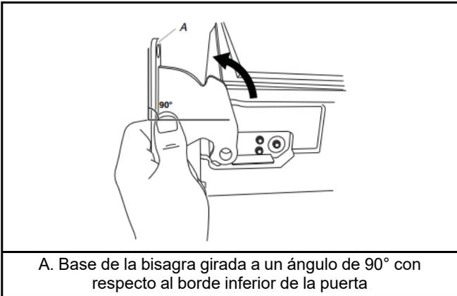
5. Retire la bisagra de la puerta. Para volver a instalar la bisagra inferior en el gabinete del refrigerador.
