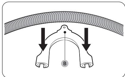
3. Faites passer le tuyau de vidange dans le système d'évacuation.
