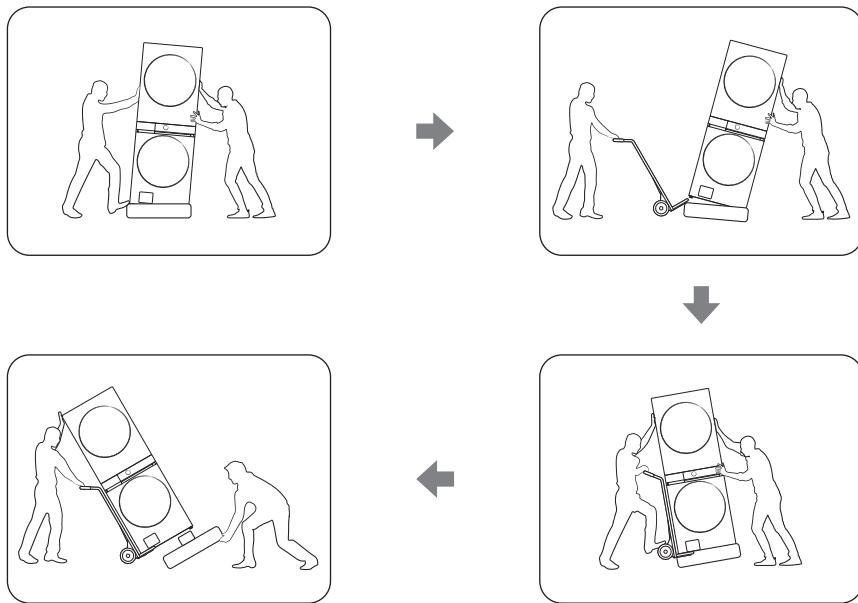
1. Inclinez le Laundry Hub sur un côté pour dégager l'espace entre le Laundry Hub et le coussin de mousse de base. Ensuite, placez un diable de manutention sous le Laundry Hub.
