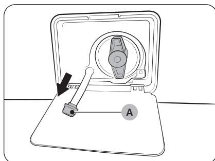
3. Placez un grand bac vide autour du cache et tirez le tuyau de vidange d'urgence jusqu'au bac tout en maintenant le bouchon du tuyau (A).
