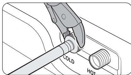
4. Reliez les tuyaux d'eau aux arrivées d'eau chaude et d'eau froide à l'arrière du Laundry Hub, puis serrez à la main les raccords des tuyaux d'eau jusqu'à ce qu'ils soient serrés. Ensuite, utilisez une pince pour serrer les raccords de deux tiers de tour supplémentaires.
