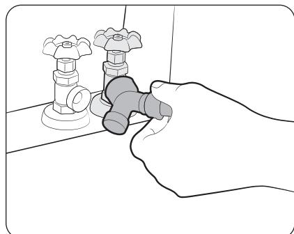
1. Fermez le robinet d'eau froide. Si le tuyau d'eau froide du lave-linge est raccordé au robinet d'eau froide, dévissez-le et débranchez-le. Branchez ensuite l'extrémité femelle du raccord en Y au robinet d'eau froide.
