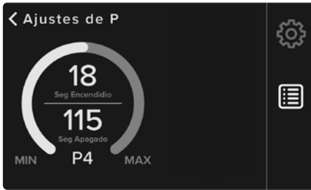
FIGURA 1: PANTALLA DE EDICIÓN DE CONFIGURACIÓN P
