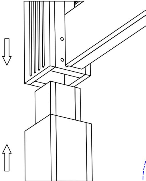
THE HEAD AND LEGS MUST BE COMPLETELY SPLICED
