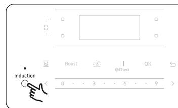
1. Appuyez sur la touche puissance (I) pendant plus d'une seconde pour activer l'appareil.
