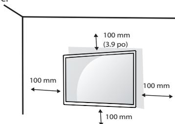
Assurez-vous d'utiliser les vis et les fixations murales qui répondent aux normes VESA. Les dimensions standards des trousse de fixation murale sont indiquées dans le tableau suivant.
