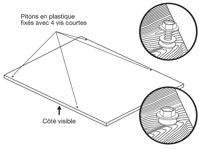
Fixer les 4 pitons en plastique au panneau de bois à l'aide des 4 vis courtes à tête hexagonale de 5/16 po fournies.
