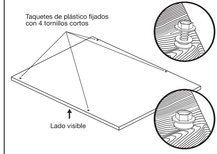
Fije los 4 taquetes de plástico en el panel de madera con los cuatro tornillos de cabeza hexagonal de 5/16" (cortos) que se proveen.
