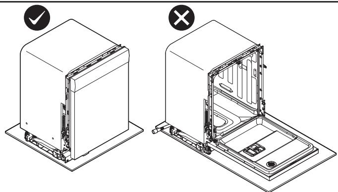
S'assurer que la porte du lave-vaisselle est fermée en tout temps pendant le réglage de la tension du ressort de charnière. Le réglage de la tension du ressort de la charnière lorsque la porte est partiellement ou complètement ouverte risque d'endommager la charnière.
