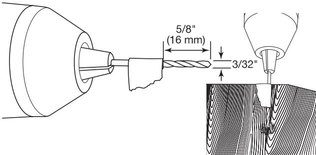
**NOTA:** No taladre a una profundidad mayor de 5/8" (16 mm) para evitar taladrar a través del panel. Las profundidades de los orificios piloto provistas son para un panel de 3/4" (19 mm) de grosor.
