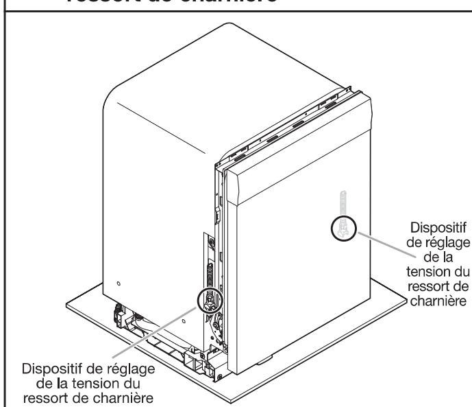
Une fois le lave-vaisselle partiellement ou complètement retiré de l'armoire, les dispositifs de réglage de tension du ressort de charnière sont accessibles sur les côtés avant du lave-vaisselle.
