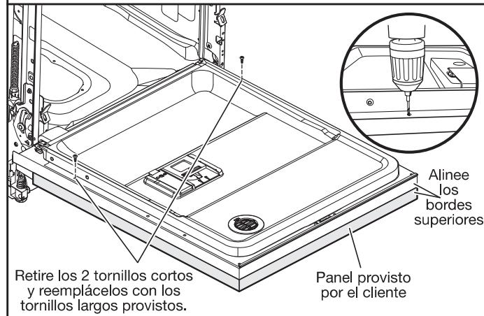
Retire los tornillos cortos (los cuartos desde la parte superior) a cada lado del panel interno de la puerta. Use cinta para marcar una broca de  $3/32"$  a fin de medir la profundidad del orificio de aproximadamente  $1\frac{1}{2}"$  (38 mm). Taladre 2 orificios piloto en el panel tomando el orificio del revestimiento de la puerta como guía. Instale los 2 tornillos largos restantes.
