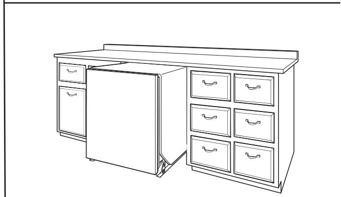
Le lave-vaisselle doit être partiellement ou complètement retiré de sous l'armoire pour permettre l'accès au mécanisme de réglage de la tension du ressort de charnière.
