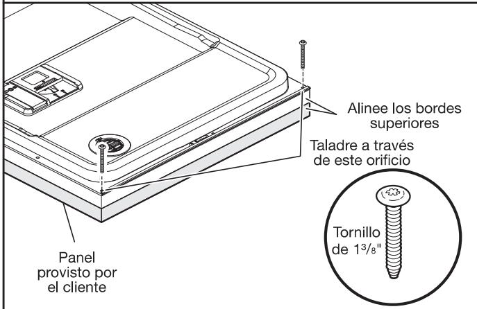
Con un destornillador Torx T15, instale dos tornillos n.º 8 x  $1\frac{3}{8}"$  (largos) en las esquinas superiores para fijar el panel de madera a la medida en su lugar.
