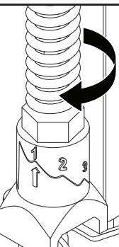
Cada bisagra tiene 3 niveles diferentes para ajustar la tensión del resorte. El nivel de tensión actual se indica con una flecha. El número 1 es el nivel de tensión más bajo, que sirve para puertas ligeras, y 3 es el nivel más alto, que sirve para puertas más pesadas. El número 2 es un nivel de tensión medio que sirve para paneles de puerta que tienen un peso intermedio.
