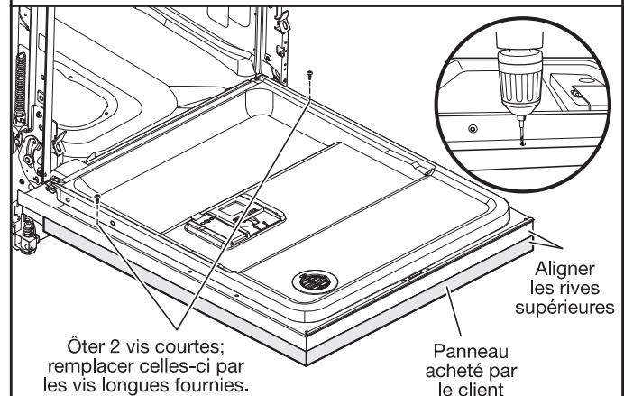
Enlever les vis courtes (4° à partir du haut) de chaque côté de l'intérieur du panneau de porte. Utiliser du ruban pour marque sur le foret de 3/32 po la profondeur de trou à ne pas dépasser d'environ 1 1/2 po (38 mm). Percer 2 avant-trous dans le panneau en utilisant les trous de montage de la porte comme guide. Fixer les 2 vis longues restantes.
