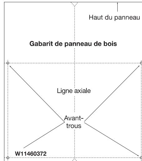
En utilisant le gabarit fourni, le fixer à l'arrière du panneau personnalisé avec du ruban adhésif. S'assurer que le centre du gabarit est aligné avec le centre du panneau de bois et que le haut du gabarit est aligné avec la face supérieure du panneau de bois.
