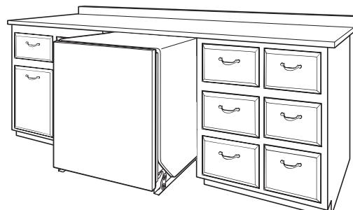
La lavavajillas se debe retirar de manera total o parcial del gabinete para poder acceder al mecanismo de ajuste de tensión del resorte de la bisagra.
