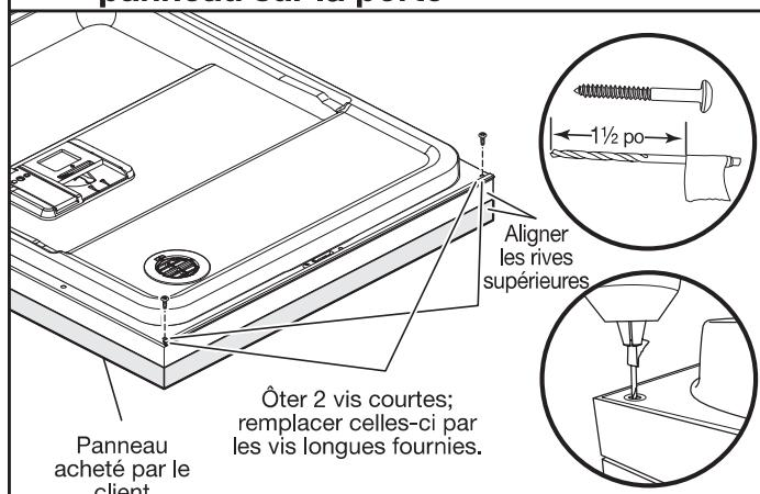
Aligner les rives supérieures du panneau sur la porte Utiliser du ruban pour marque sur le foret de 3/32 po la profondeur de trou à ne pas dépasser d'environ 1 1/2 po (38 mm). Percer des avant-trous dans les coins supérieurs de la porte, en utilisant le trou dans la doublure comme guide.
