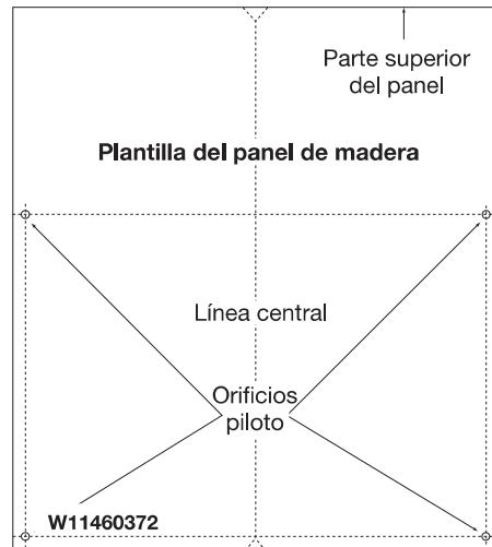
Fije la plantilla provista a la parte de atrás del panel a la medida con cinta adhesiva. Asegúrese de que el centro de la plantilla esté alineado con el centro del panel de madera y que la parte de arriba de la plantilla esté alineada con la cara superior del panel de madera.
