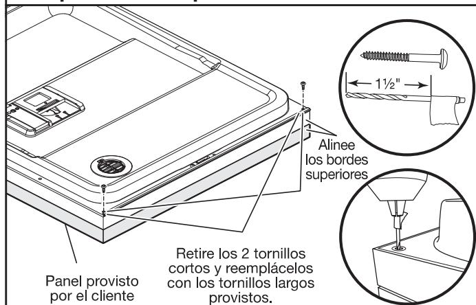
Alinee los taquetes del panel a la medida con las ranuras en forma de bocallave ubicadas en el ensamblaje de la puerta. Asegúrese de que los 4 taquetes de plástico estén dentro de las ranuras de bocallave. Deslice el panel de madera hacia abajo hasta que la superficie superior del panel de madera esté al ras con la parte superior de la puerta.
