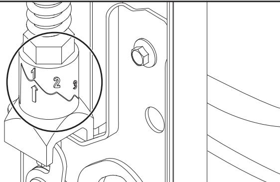
Chaque charnière comporte 3 niveaux de tension de ressort différents sur lesquels elle peut être réglée. Le niveau de tension actuel est indiqué par une flèche. 1 est la tension de ressort la plus basse pour les portes légères et 3 est la plus élevée pour les portes plus lourdes. 2 est la tension moyenne pour les poids des panneaux de porte qui se situent entre lourd et léger.
