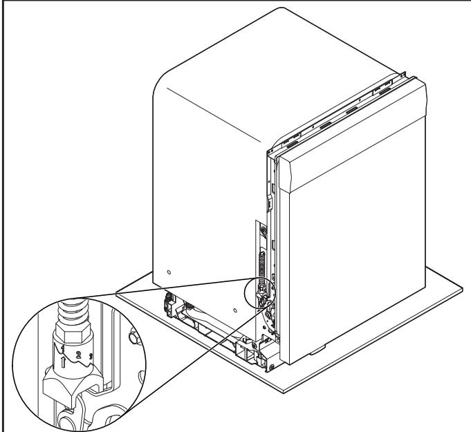
Cada una de las bisagras (de la izquierda y de la derecha) tienen 3 niveles diferentes de tensión de los resortes. Todos los modelos de lavavajillas salen de fábrica con las bisagras fijadas en el nivel de tensión de resorte más bajo. Este nivel es apto para los paneles de puerta más ligeros. Para los paneles más pesados, se deberá ajustar el nivel de tensión del resorte de la bisagra para evitar que la puerta se abra cuando no esté trabada.
