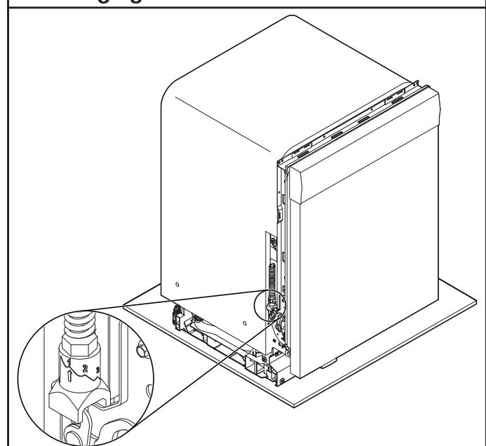
Chacune des deux charnières (côté droit et côté gauche) comporte 3 réglages de tension de ressort différents. Tous les modèles de lave-vaisselle quittent l'usine avec les charnières réglées sur le réglage de tension de ressort le plus bas. Ce réglage convient aux panneaux de porte plus légers. Les panneaux de porte plus lourds nécessiteront un ajustement de la tension du ressort de charnière pour empêcher la porte de s'ouvrir lorsqu'elle est déverrouillée.
