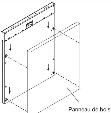
Aligner les goujons du panneau de bois personnalisé avec les encoches en trou de serrure de la porte. Vérifier que les 4 pitons en plastique sont bien engagés dans les encoches en trou de serrure. Glisser le panneau de bois vers le bas jusqu'à ce que sa surface soit en affleurement avec le sommet de la porte.
