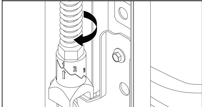
Tourner l'écrou de réglage à l'aide d'une clé à fourche de 3/4 po ou d'une clé à molette d'un ou deux cran dans le sens horaire vu de dessus pour augmenter la tension du ressort.
