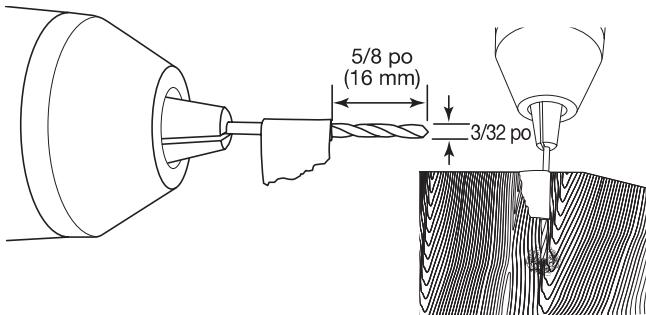
**REMARQUE :** Ne pas percer plus profondément que 5/8 po (16 mm) pour ne pas percer à travers le panneau. Les profondeurs des avant-trous indiquées sont pour des panneaux de 3/4 po (19 mm) d'épaisseur.
