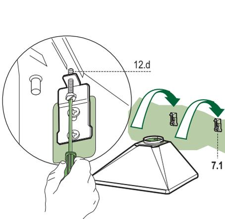
Atornille los dos tornillos 12d provistos en los soportes 7.1.
