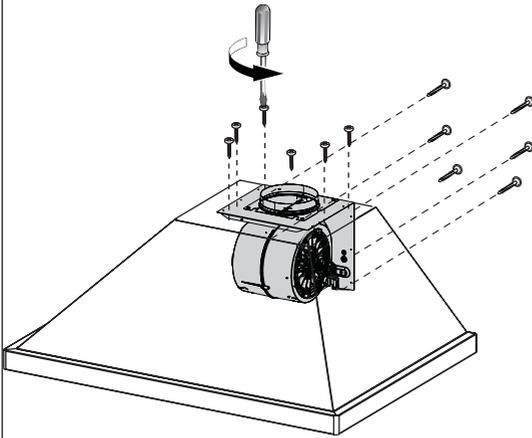
Para una instalación de conductos horizontales, el motor no necesita ser asegurado retirando primero los 12 tornillos como se muestra.
