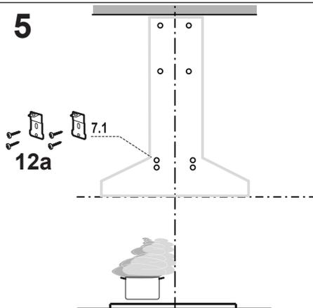
Fixer les supports 7.1 en utilisant les vis 12a fournies dans les trous de fixation du corps de la hotte, comme indiqué.
