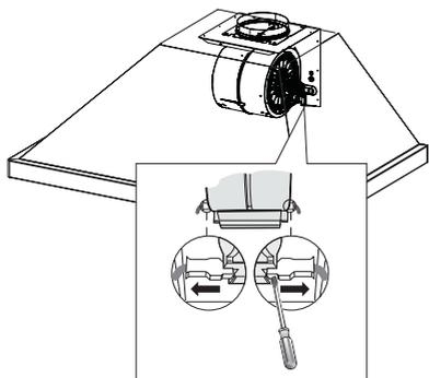
Débranchez le connecteur électrique en appuyant sur les pattes à l'aide de la main et en exerçant une légère force sur une des pattes à l'aide d'un tournevis à lame plate.
