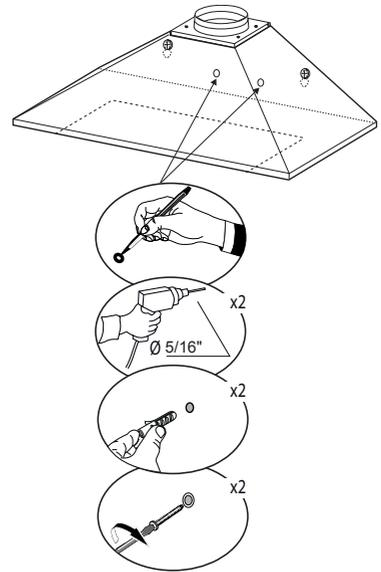
Desde el interior del cuerpo de la campana, marque el orificio de seguridad, taladre  $\varnothing$  5/16" donde está marcado, inserte 2 tacos de pared 11 en los orificios y fíjelos con 2 tornillos.
