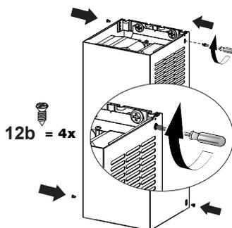
Asegure los lados a los soportes con los 4 tornillos 12b.
