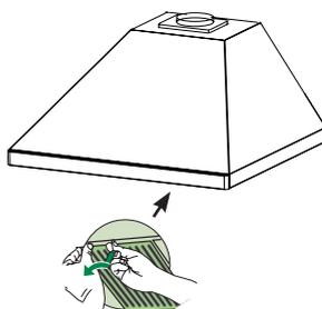
Reemplace los filtros de grasa metálicos retirados previamente.
