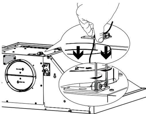
Vuelva a conectar el conector al ventilador.
