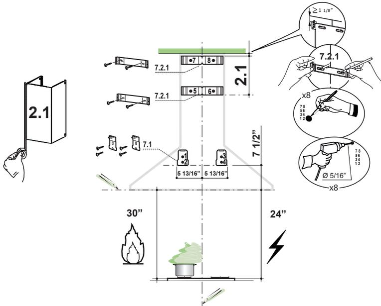
Placez la bride supérieure 7.2.1 sur le mur comme illustré, à environ 1/8" du plafond ou de la limite supérieure, en alignant les centres (encoche) avec la ligne de référence verticale. Marquez l'emplacement du centre des trous de la bride sur le mur.
