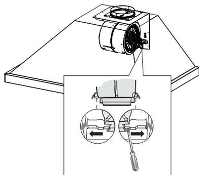
Desconecte el conector eléctrico presionando las pestañas con la mano y también utilizando una fuerza ligera en una pestaña con un destornillador de cabeza plana.
