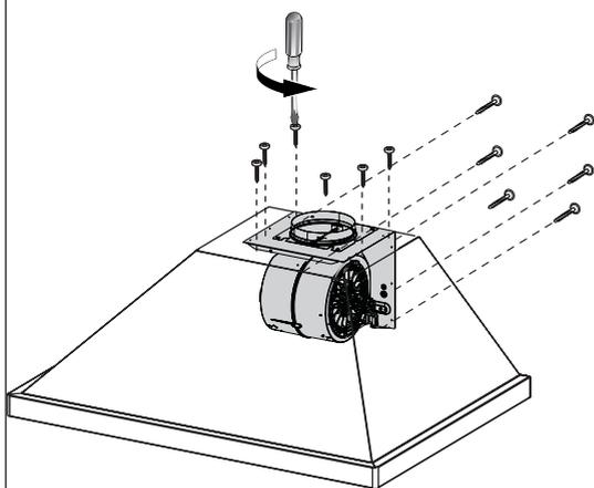
Pour l'installation d'une canalisation horizontale, le moteur doit d'abord être détaché. Pour ce faire, retirez les 12 vis comme illustré.
