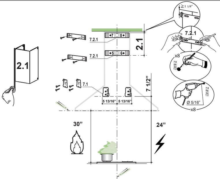
Coloque la brida superior 7.2.1 en la pared como se muestra, aproximadamente a 1 1/8" del techo o límite superior, alineando los centros (muesca) con la línea de referencia vertical. Marque la ubicación del centro de los agujeros en la pared.
