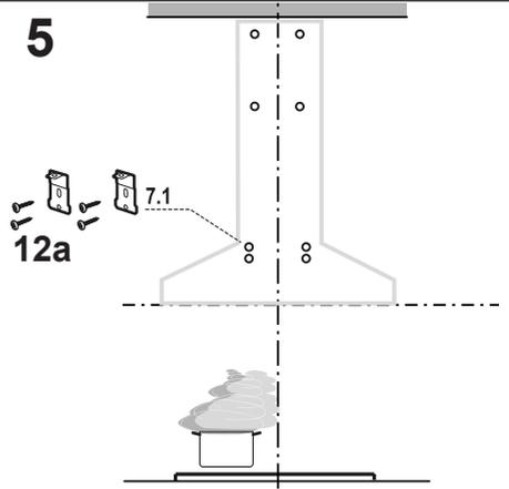
Asegure los soportes 7.1 con los tornillos 12a provistos en los orificios de montaje del cuerpo de la campana, como se muestra.
