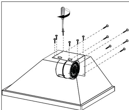
Una vez que el ventilador esté en su lugar, vuelva a instalar los 12 tornillos para sujetar el motor al cuerpo de la campana.
