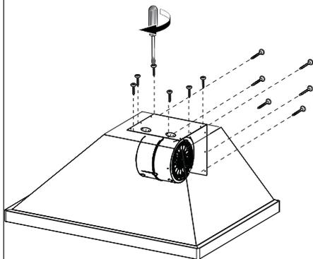
Une fois le ventilateur en place, réinstallez les 12 vis pour fixer le moteur au corps de la hotte.
