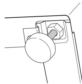
**REMARQUE :** pour réduire la vibration, les contre-écrous doivent être serrés.
