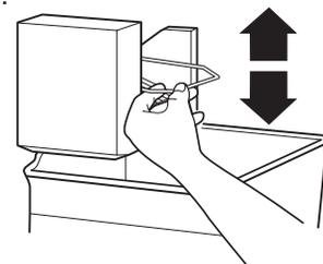
**REMARQUE :** Éteindre la machine à glaçons avant de retirer le bac d'entreposage à glaçons pour servir des glaçons ou pour nettoyer le bac. Ceci empêchera les glaçons de tomber de la machine à glaçons et dans le compartiment de congélation. Après avoir remplacé le bac d'entreposage, mettre en marche la machine à glaçons.
