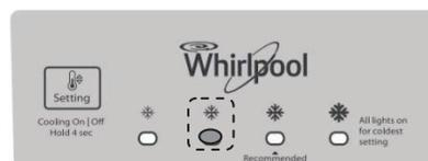
La température médiane minimum est indiquée lorsqu'on appuie une fois sur le bouton Setting (réglage) à partir de la température la moins froide. Le deuxième témoin s'allume.
