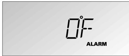
Une alarme de température se signale par le clignotement de la température requise et l'allumage du symbole **ALARM**. Un signal retentit également si vous avez activé la fonction Signal sonore (*SONNERIE*) dans le mode Configuration.
