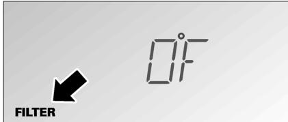
Cela signifie que la durée de vie maximale du filtre est sur le point d'expirer. Veuillez commander un nouveau filtre « UltraClarity ».
