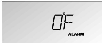
Se indica una alarma respecto de la temperatura a través de una visualización intermitente de la misma y el encendido de la señal de **ALARM(a)**. También suena un sonido de alarma, siempre que esté activado este método en el modo de setup.
