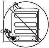
• **NE PAS plier le conduit.** Utilisez des coudes pour les virages si nécessaire.
