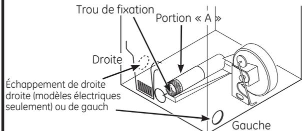
Rebranchez la portion coupée (A) du conduit au boîtier de ventilateur. Assurez-vous que le conduit raccourci soit aligné avec la base de la languette. Utilisez la vis mise de côté précédemment pour fixer le conduit à la languette sur la base de l'appareil.
