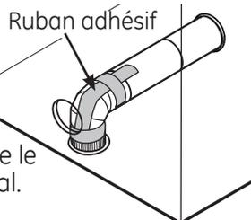
Les joints de conduits internes doivent être scellés avec du ruban adhésif sinon ils peuvent se séparer et provoquer un danger pour la sécurité.
