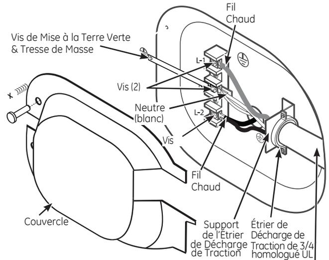
3 conducteurs de cuivre #10 AWG ou l'ensemble de cordon électrique pour sècheuse de 120/240V 30A et des cosses rondes fermées ou des cosses en fourche avec extrémités relevées (non inclus).
