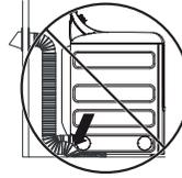
• **NE PAS installer la sècheuse sur le conduit.**
