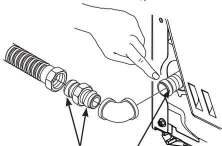
Appliquez de la pâte à joint au raccord et au tuyau d'arrivée de la sécheuse
