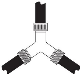
4. Insérez la crépine dans le raccord du joint du tuyau d'arrivée. Si un joint plat en caoutchouc est déjà en place, enlevez-le avant d'installer la crépine. Attachez cet embout à un embout mâle et à l'embout en « Y ». Serrez fermement à la main.
