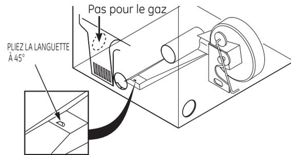
Par l'ouverture arrière, repérez la languette au milieu de la base de l'appareil. Levez la languette jusqu'à environ 45°, en utilisant un tournevis plat.
