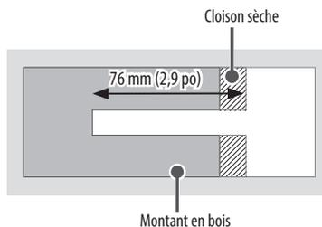
Utilisez la mèche pour le bois de 4 mm de diamètre pour percer des trous d'une profondeur de 76 mm (2,9 po). (Enlevez les résidus à l'intérieur des trous percés.)
